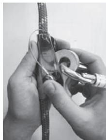
6 Alinhe os canais do came e do corpo (orifícios) para o encaixe do eixo. Coloque o eixo até o fim e aperte-o até ouvir um som de "TEC", isso significa que o eixo estará travado. Caso o eixo não esteja corretamente fechado, a mola o "expulsará" para fora. Ele não deverá sair! Teste o sentido de travamento do trava queda antes de iniciar o trabalho puxando-o para baixo e certifique-se que o sistema esteja funcionando perfeitamente.
