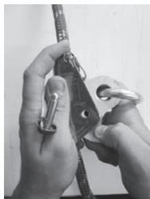
5 Insira a corda dentro do corpo do trava queda, encaixando na sequência o came, utilizando a ajuda do pino guia do came.
