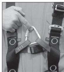
Conecte a malha rápida triangular nos dois anéis têxteis (vermelho) do ponto peitoral.
