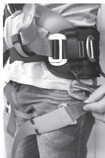
Vista o cinto com as pernas posicionando as alças e fivelas à frente do corpo.
