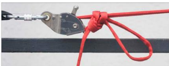
Nó de pescador para bloquear a ancoragem
