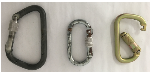
CONECTORES A SEREM DESCARTADOS Descarte os conectores que apresentarem mal funcionamento mecânico, pontos de corrosão, fissuras, desalinhamento ou qualquer outro fator que altere sua integridade
