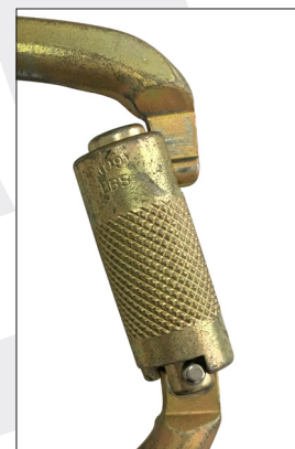
SISTEMA DE BLOQUEIO COM DEFEITO
